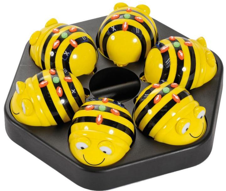
Il robot educativo Bee-Bot si accende facilmente premendo uno dei pulsanti. Il può avanzare, tornare indietro, ruotare di 90 gradi e fermarsi quando incontra ostacoli. Può essere ricaricato con un cavo USB, va in standby senza essere utilizzato dopo due minuti e ha un'autonomia di 8 ore.
